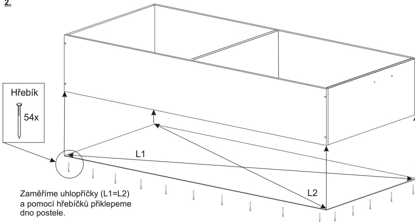
Zaměříme uhlopříčky (L1=L2) a pomocí hřebíčků přiklepeme dno postele.
