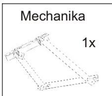
Pomocí vratových šroubů M6x35, podložky o 6mm a matice M6 přišroubujeme mechaniky.
