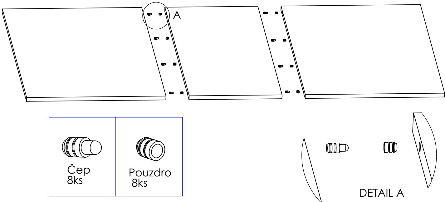
6. Na pevnou plochu (podlahu) položte nějakou podložku(karton, filc), aby nedošlo k poškrábání stolových desek. Na podložku položte stolové desky tak, aby strana na kterou se chcete dívat byla směrem dolů. Následně založte do lišt rozkladu plastové díly rozkladu 4ks do každé lišty, sestavte rám stolu (nohy+sokly+dno) nohami vzhůru na stolovou desku. NEZAPOMEŇTE NA LEPIDLO!!! Počkejte, až lepidlo zaschne, aby nedošlo k poškození konstrukce stolu!
