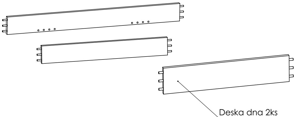
3. Do dlouhé soklové desky s otvory v ploše našroubujeme lištu rozkladu ze stejné strany jako jsou otvory v ploše cca 0,5mm pod horní plochu vruty 3,5x16. Do prostředních otvorů zašroubujeme dorazové šroubky
